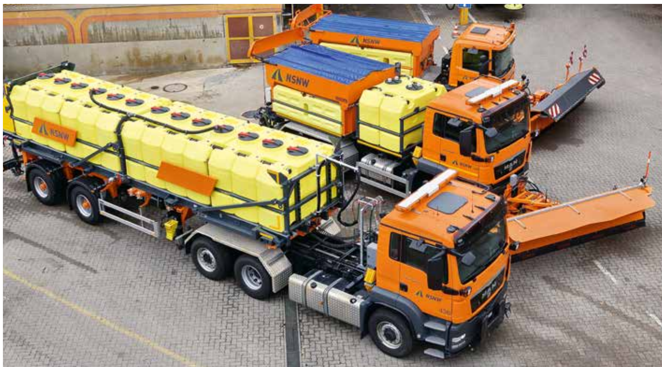
4 | Die verschiedenen Streutechnologien für den Winterdienst, v.l.: Sole-, Kombi-Feuchtsalz/Sole- und Feuchtsalz-Sprüher (Foto: NSNW).
